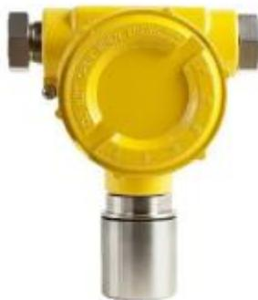
Определяемые газы: горючие газы; Метод измерений: каталитический; Точность:  $\leq \pm 5\% F.S$ ;
